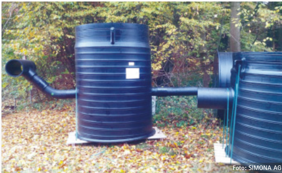
Bild 2: Die SIMONA Kunststoffwerkstatt baute 19 kundenspezifische Schächte aus PE 100 mit passenden Anschlüssen
