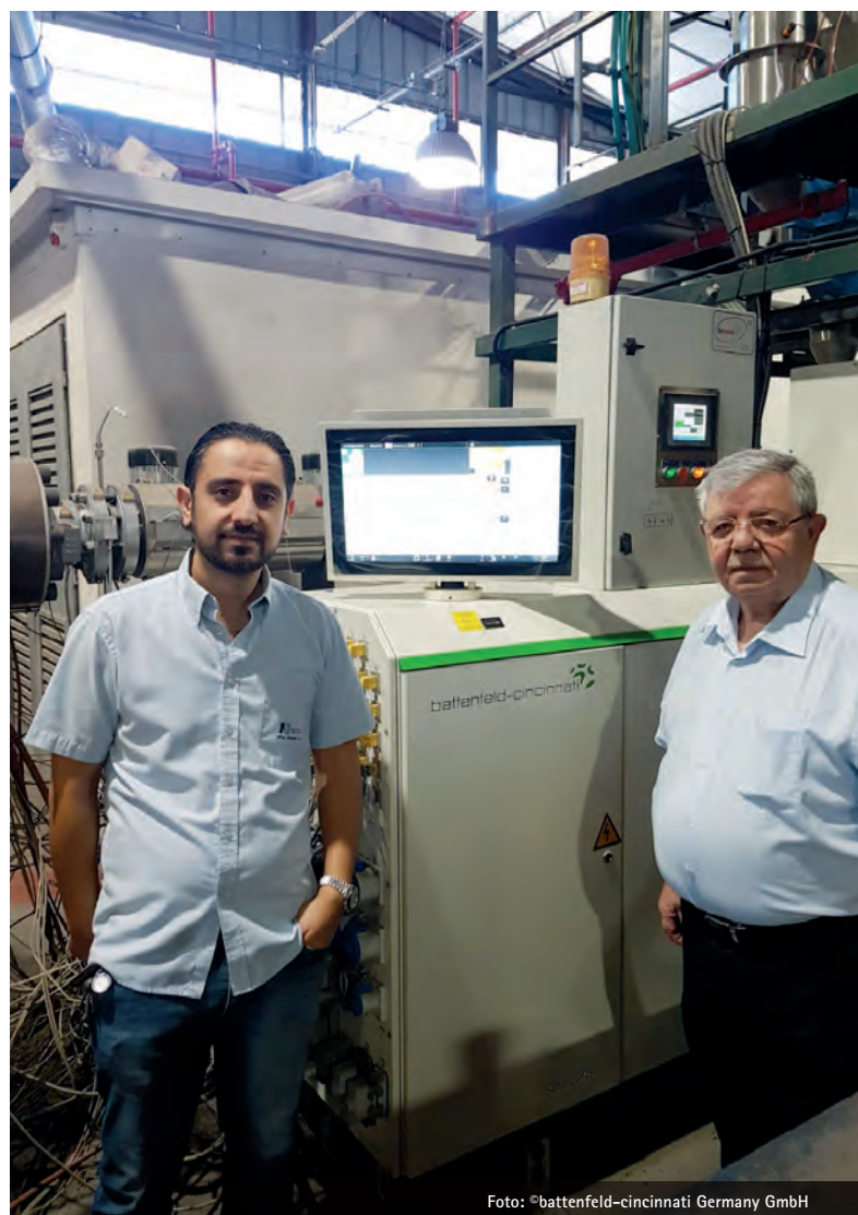
Bild 2: von links Rami Dweik und Furad Dweik zeigen den solEXNG 75-40 Hochleistungs-Einschneckenextruder
