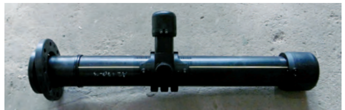
Bild 3: Prüfmuster Druckanbohrarmatur (DAA) für H 2 -Dichtheitsprüfungen
