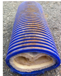
Rohre mit Dämmmaterial
