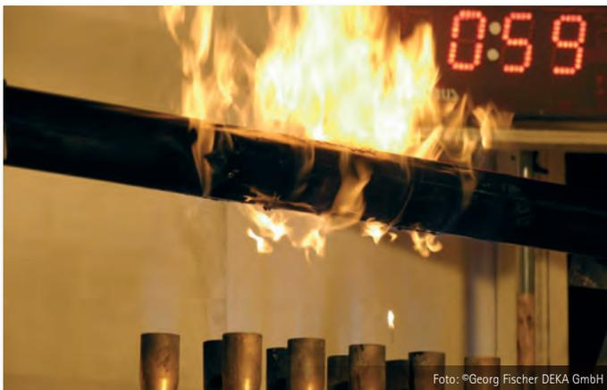
**Sammelbalken aus elektrisch leitfähigem Polyethylen**
