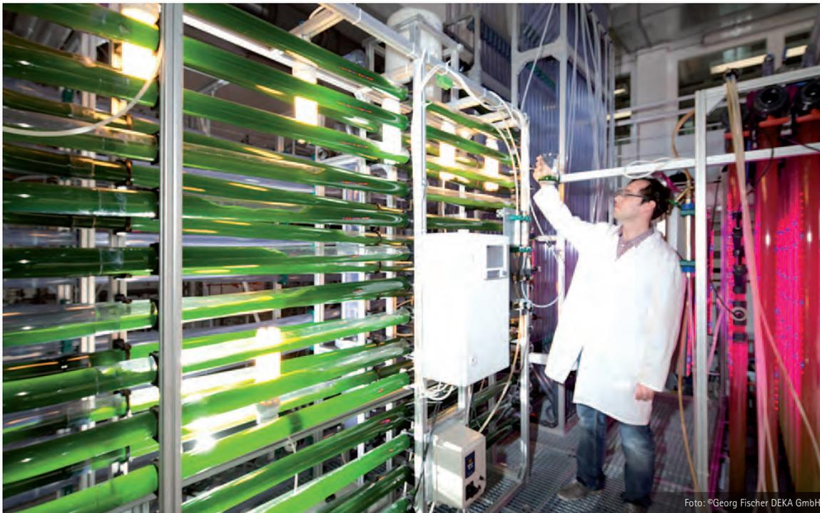
Bioreaktoren aus Kunststoffrohren zur Kultivierung von Algen als Rohstoff für die Kosmetikindustrie, Nahrungsmittelproduktion oder zur Herstellung von Biokraftstoff
