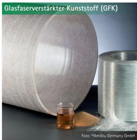
Als Verbund-Liner-Rohre bezeichnet man zum Beispiel Rohre aus GFK mit einem Innenrohr (Inliner) aus Thermoplasten wie PE, PP, PVC-U, PVC-C, PA oder PVDF. Mit dem Inliner werden die gewünschte chemische Widerstandsfähigkeit und mit dem GFK-Ver-
